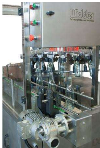
نقاله خروجی و تابلو کنترل دستگاه
